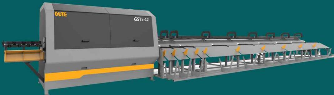
\*скорость выпрямления и мерной резки до 120 м/мин.!
